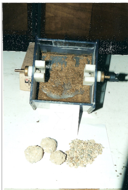
70 kg τσιμέντο / \text{m}^3 Δείκτης χαλάρωσης I_d=66\% (μέτρια ανθεκτικότητα)
