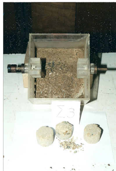
150 kg τσιμέντο / \text{m}^3 Δείκτης χαλάρωσης I_d=89\% (μέτρια υψηλή ανθεκτικότητα)
